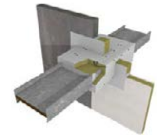
Detail D1 – průstup s izolací z desek z minerální vlny
